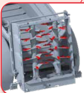
Verwisselbare en omkeerbare messen in HARDOX 450
